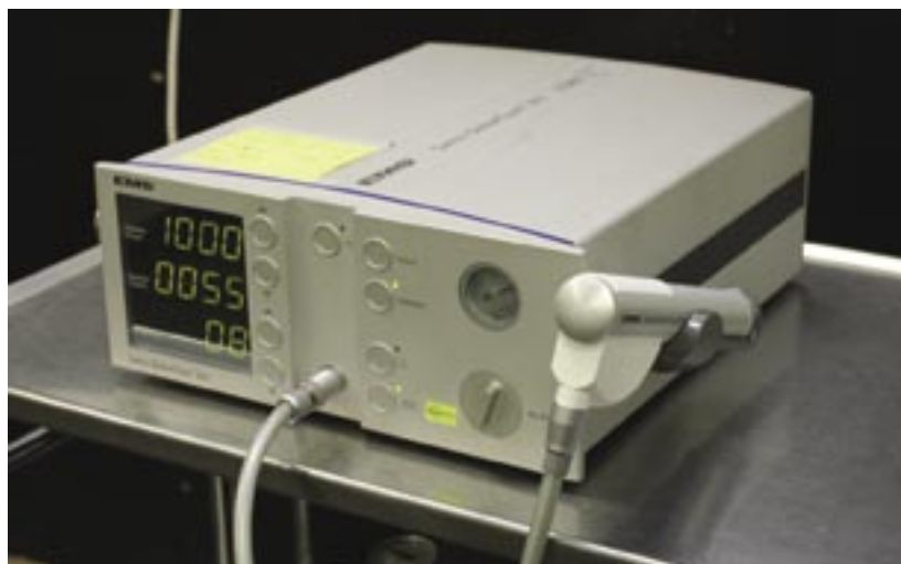
Romme-klinikens apparat, vid fotograferingstillfället förinställd på 1 000 impulser, varav 55 finns kvar. Nederst visas impulsernas hastighet, i det här fallet 8 hertz. Till höger syns applikatoren med vilken smärtområdet behandlas. Det här är en radial, det vill säga icke-fokuserad, shockwave.
